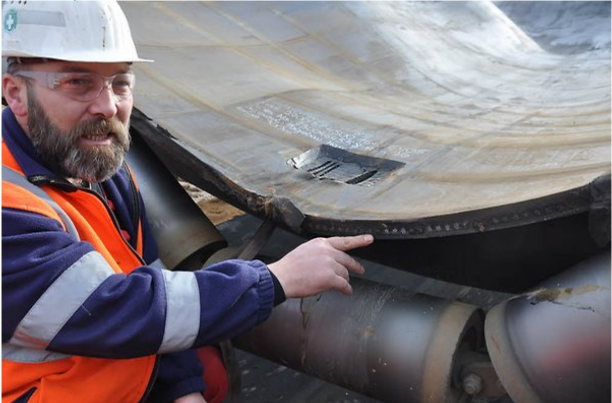
167 Stahlseile tragen ein durchschnittlich 2,65 Meter breites und 32 Millimeter dickes Förderband, wie Ali Yildirim (links) erklärt. Foto Dietmar Fratz
